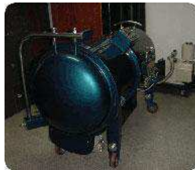
pav. Dėžės su eksponatais supakuotos į polietileninę plėvelę ir specialiu įrenginiu pakuotėje sudaroma bedegvonė aplinka.
