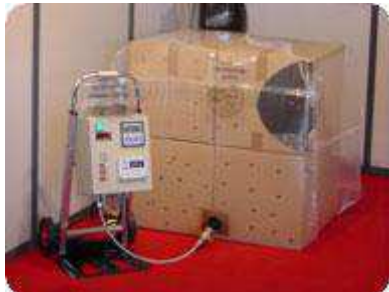
pav. Dėžės su eksponatais supakuotos į polietileninę plėvelę ir specialiu įrenginiu pakuotėje sudaroma bedegvonė aplinka.
